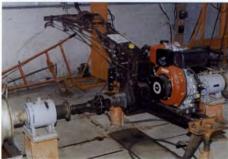
รูปที่ 7 การทดสอบความทนทานของชิ้นส่วนส่งกำลังและกลไกของรถไถเดินตาม
