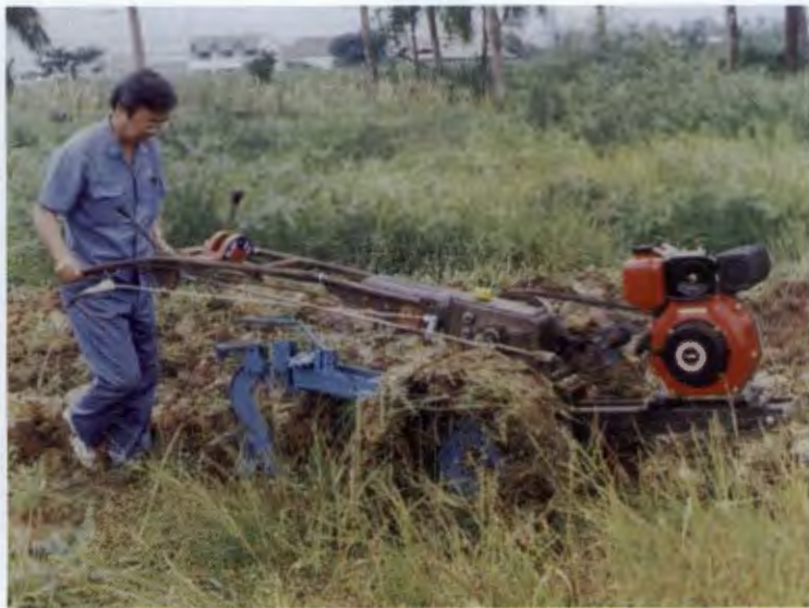
รูปที่ 8 การทดสอบรถไถเดินตามต้นแบบในพื้นที่นา
