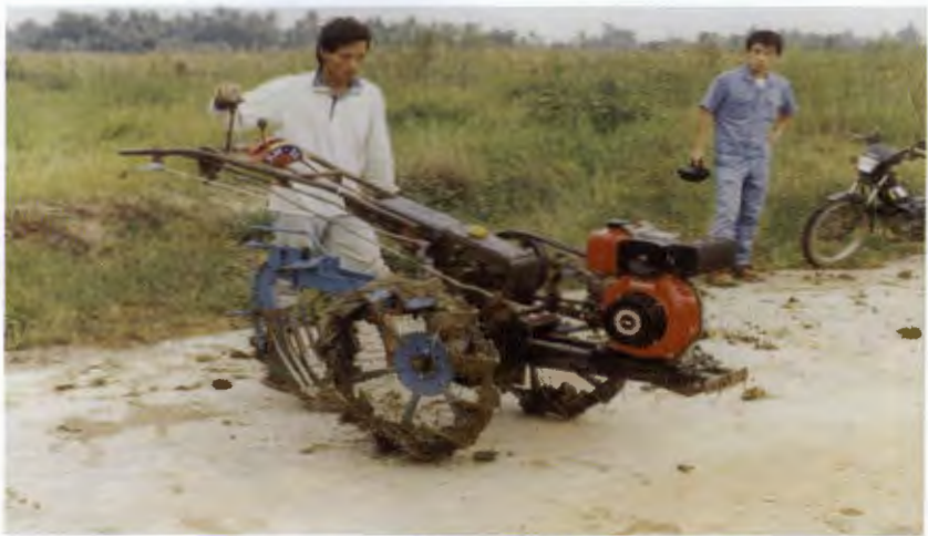
ที่มา: “รถไถเดินตามพร้อมไถหมุนและล้อเหล็กสำหรับเตรียมดินนา” นักประดิษฐ์ นายสุรินทร์ พงศ์ศุภสมิทธิ และคณะ ภาควิชาวิศวกรรมเครื่องกล คณะวิศวกรรมศาสตร์ จุฬาลงกรณ์มหาวิทยาลัย
